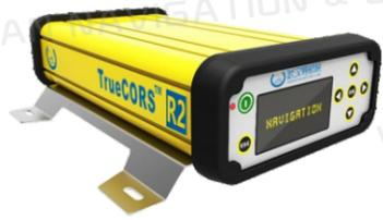
TrueCORS R2是导航院新一代全系统全频点高精度CORS接收机，支持北斗全球信号，包括B1C、B2a、B2b、B3I。可提供毫米级载波相位观测输出，主机系统稳定性强，网络管理功能强大。具有良好的人机交互，提供RJ45、Bluetooth、WiFi、3.5G网络通讯，支持TCP/IP、HTTP、NTRIP和FTP等通讯协议，可通过网络接口传输原始观测数据、实时差分数据和观测文件，提供基于Web的控制界面，可通过Internet浏览器远程访问和控制。内置大容量锂电池和存储器，抗干扰能力强、稳定性高、功耗低。采用坚固铝合金外壳和密闭胶圈设计，具有优秀的防摔、减震性能，通过IP67认证，很好的满足CORS长期无人值守的环境。
