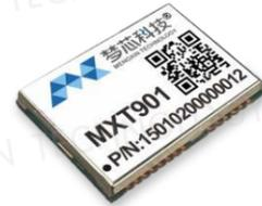
MXT901系列模块，是梦芯科技推出的普通精度导航定位模块，该系列模块采用梦芯科技完全自主知识产权的启梦®芯片，针对不同的应用需求和细分应用市场，引申出的各类不同型号普通导航定位模块，以满足客户各类应用需求。MXT901系列模块具备高灵敏度、高精度、抗干扰、低成本等特点，能够在复杂应用环境中快速精准定位，为客户提供高性价比的导航定位服务。
